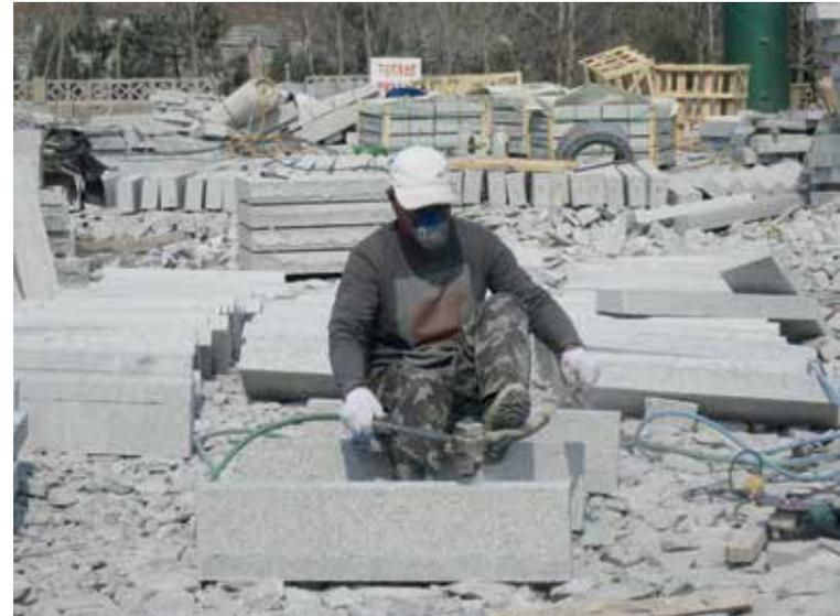
Bodenplatten für den Außenbereich werden in einem Betrieb im Norden Chinas gestockt
