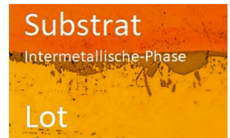
Abb. 2: Intermetallische-Phase zwischen SnAg-Lot und Cu-Substrat
