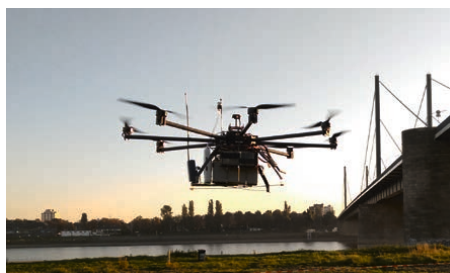
UMT Messdrohne (Oktokopter) bei Luftschadstoffuntersuchungen an der Theodor-Heuss-Brücke, Düsseldorf
